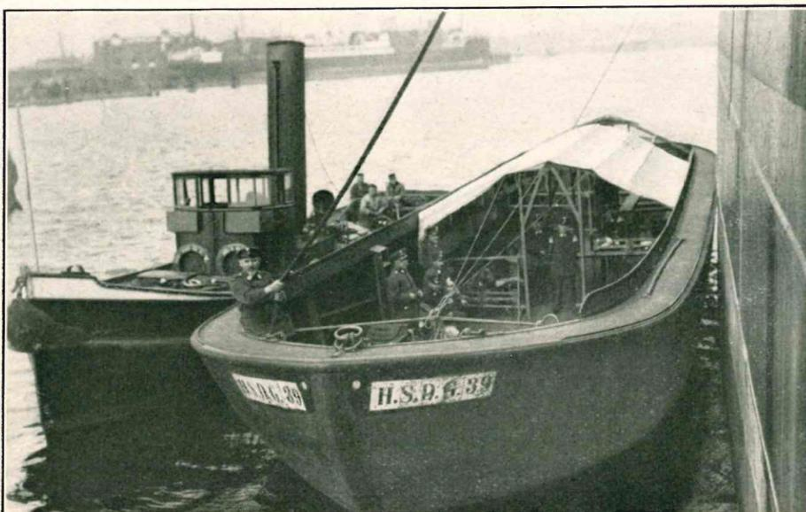
Hamburger Kranken-Lagerungssystem, eingebaut in eine Schute (Flußfahrzeug)
